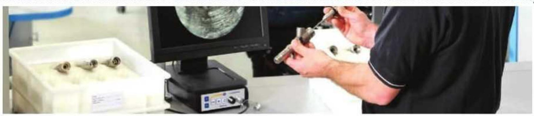
Kaynak sonrası %100 endoskopik video ile görüntüleme ve istendiğinde X-Ray kontrolü yapılmaktadır.
